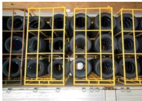
輸送架台を使用した積載
