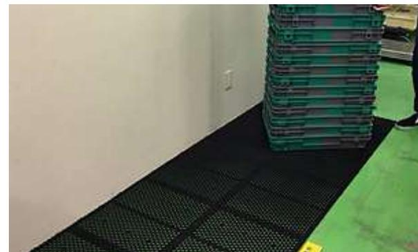
**積載物を滑らせて軽く移動できる床置きパネル
