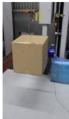
落下試験機での 落下実施状況 (底面落下)
