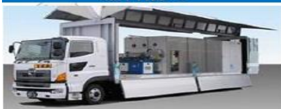
(イメージ)移動式水素ステーションカー
